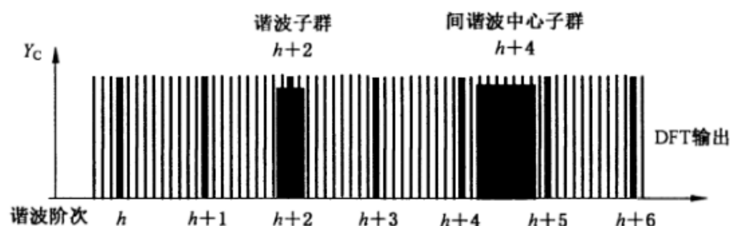
图 6 谐波子群和间谐波中心子群示例(图示为 50 Hz 电源)
